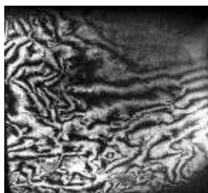
Рис. 8. Лазерная интерферометрия арболита при различном уровне нагружения а – интерферограмма образца при 0,39\sigma_p ; б – тот же образец с идентификацией аномальных перемещений; в – интерферограмма образца при 0,55\sigma_p ; г – 3D-график перемещений при 0,55\sigma_p (см. пояснения в тексте)
